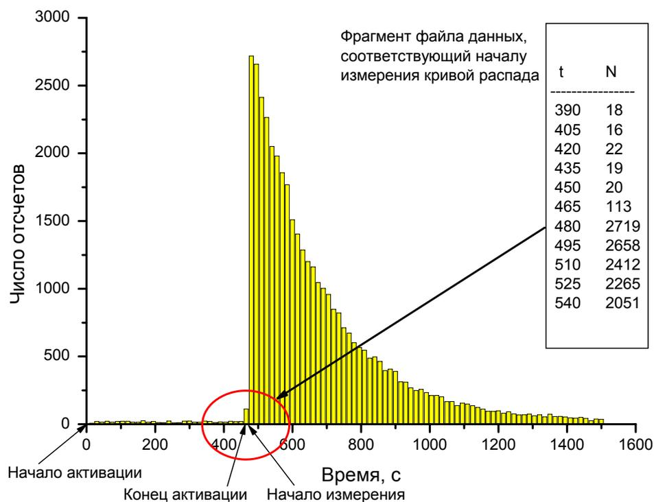
Рис. 5. Пример графического отображения файла данных. Измерение включает в себя как время активации, так и время, в течение которого происходит распад ядер  $^{28}\text{Al}$ .
