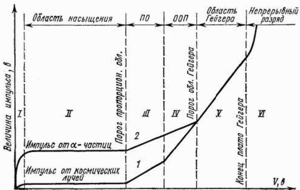
Рис. 14. Вольт-амперная характеристика ионизационного детектора.
