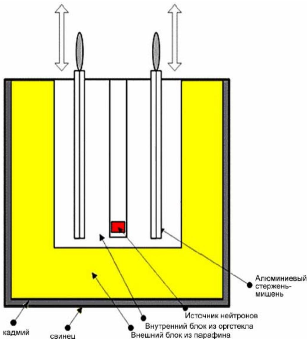
Рис. 3: Схема установки для облучения алюминиевых стержней.
