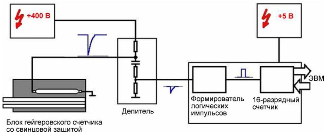
Рис. 4: Схема установки для измерения активности изотопа.
