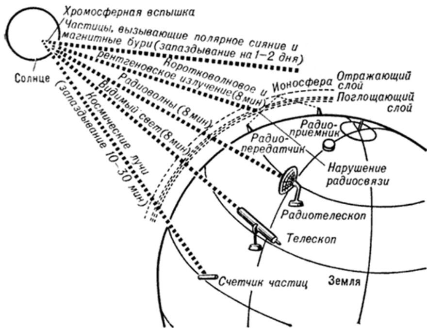
Рис. 34. Виды воздействия солнечной вспышки на Землю и методы наблюдений космического излучения.
