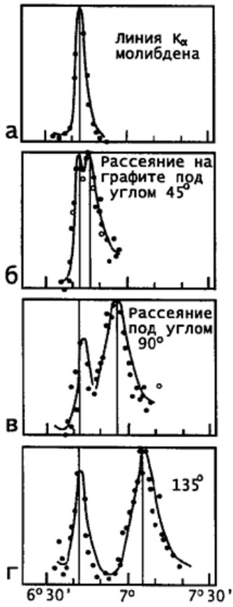
Рис. 13. Зависимость интенсивности комптоновского рассеяния от угла рассеяния фотона. Пики слева на всех графиках отвечают фотонам с исходной длиной волны, которые рассеиваются на сильно связанных электронах в атомах с эффективной массой, равной массе атома.
