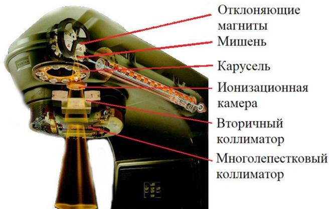
Рис. 6. Схема головки ускорителя Varian.
