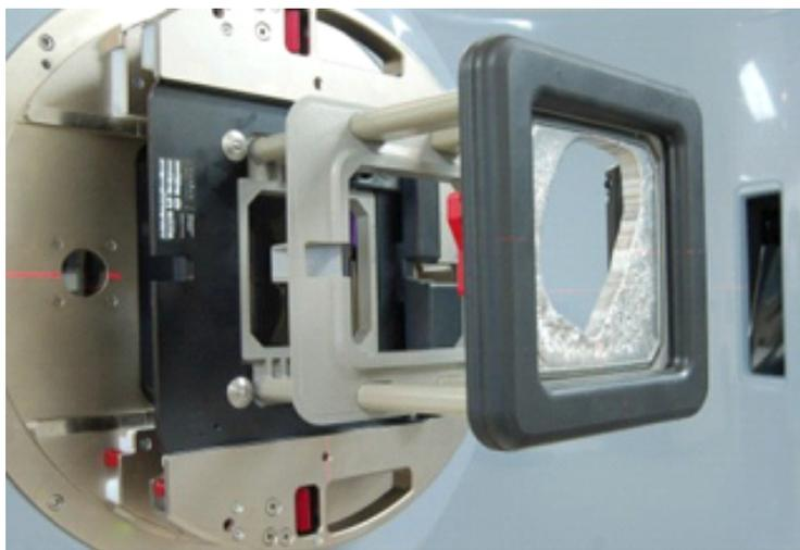
Рис. 8. Аппликатор с блоком из сплава Вуда, фирма Varian.
