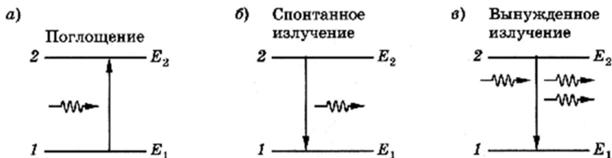
Рис. 1. Типы взаимодействия света с атомом на примере двух уровней E_1 и E_2
