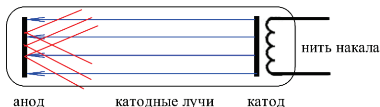
Рис. 1.2. Разрядная трубка. При попадании катодных лучей на стекло трубки или на анод внутри нее возникает излучение, проникающее сквозь непрозрачные материалы.
