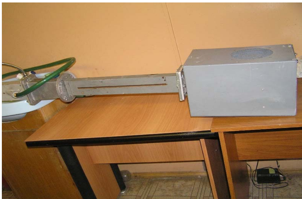
Рис. 4. Общий вид секции экспериментальной установки волноводного типа.
