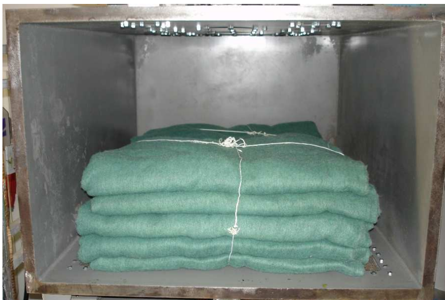
Рис.2. Камера СВЧ нагрева с помещенным внутри неё обрабатываемым материалом (10 шерстяных одеял).
