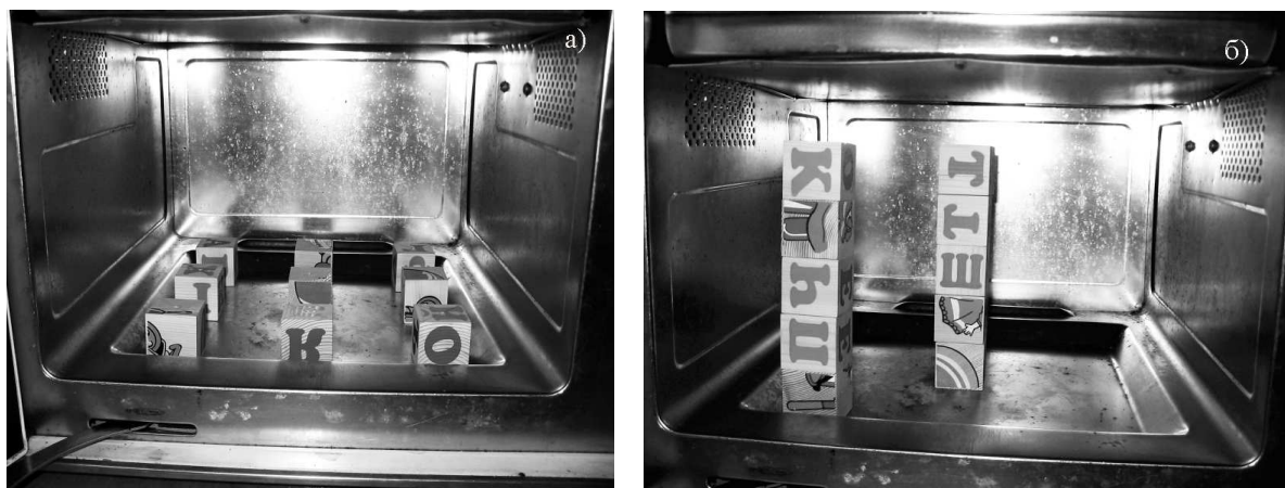
Рис. 1. Экспериментальная СВЧ камера с исследуемым материалом.
