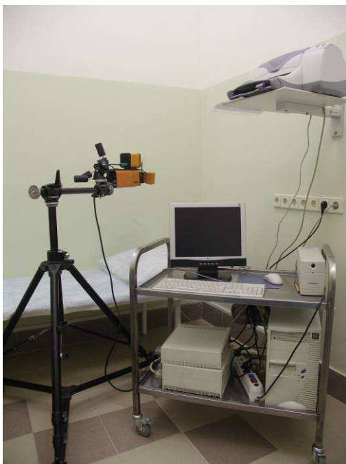
Рис. 5. Общий вид лазерной диагностической установки, работающей в ЦКБ №2 ОАО «РЖД».
