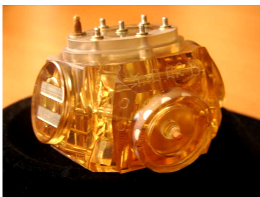
Рис. 4. Резонатор кольцевого лазерного гироскопа.
