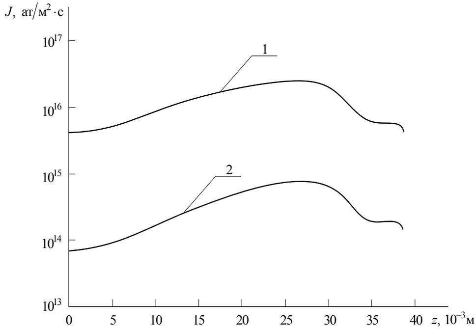
Рис. 2. Распределение плотности потока эмиссионного вещества вдоль стенки разрядной колбы лампы: 1 – на этапе зажигания; 2 – в установившемся режиме
