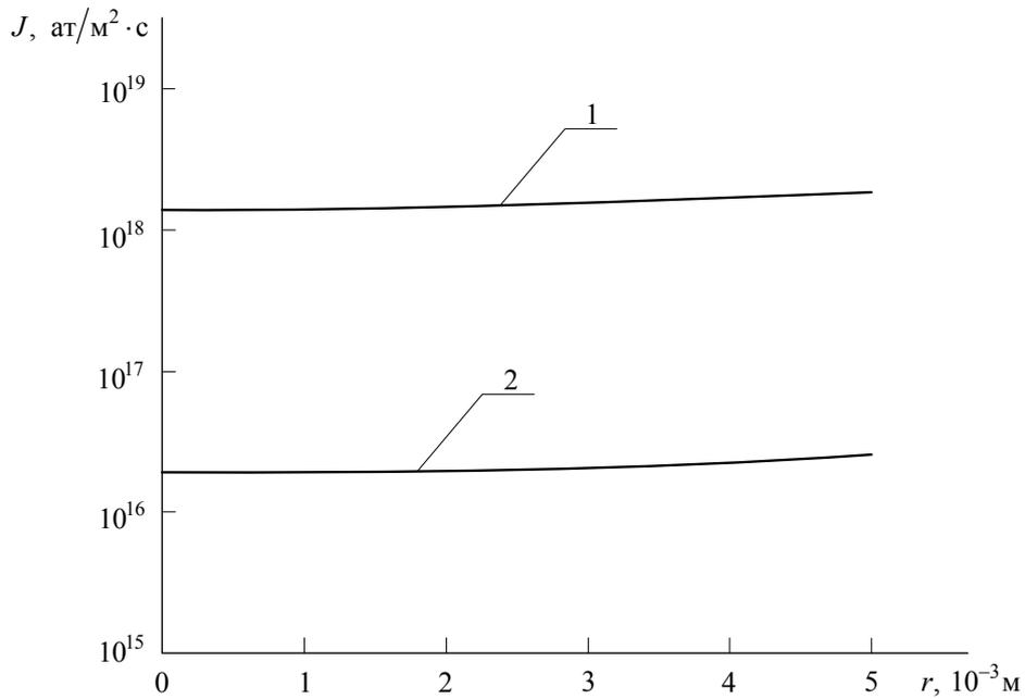
Рис. 3. Распределение плотности потока эмиссионного вещества вдоль торца керн электрода: 1 – на этапе зажигания; 2 – в установившемся режиме
