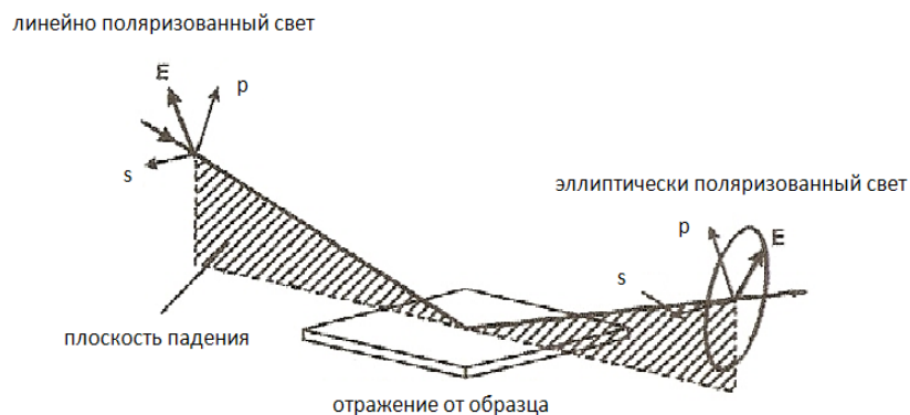
Рис. 1. Взаимодействие поляризованного света с образцом.
