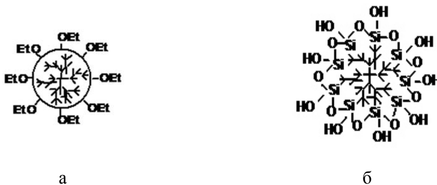
Рис. 2. Структуры сверхразветвленных полиорганосилоксанов: а – СПЭС; б – СЗ
