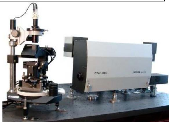
Рис. 4. Установка «зондовая нанолaborатория ИНТЕГРА Спектра»
