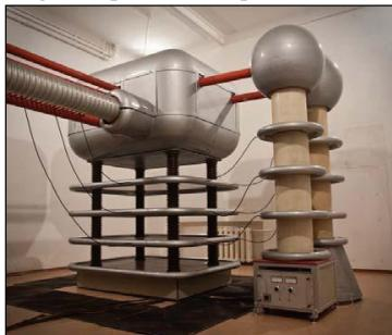
Рис. 1. Ускоритель ионов до 500 кэВ
