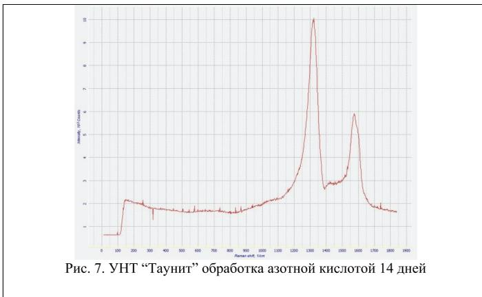
Рис. 7. УНТ “Таунит” обработка азотной кислотой 14 дней
