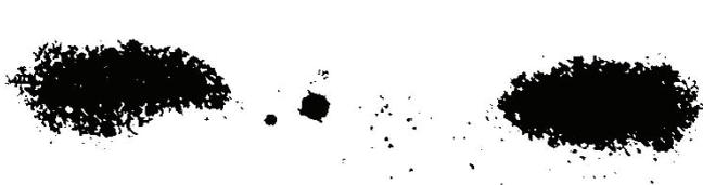
Рис. 7. Результат исследования взаимного кулоновского отталкивания двух капельных струй
