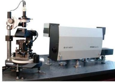
Рис. 4. Установка «зондовая нанолaborатория ИНТЕГРА Спектра»
