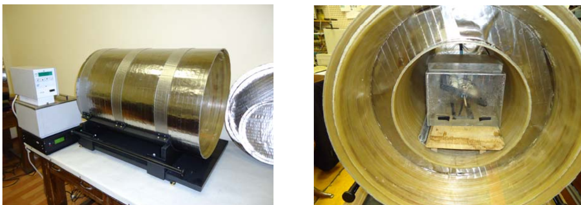
Рис.1. Общий вид гипомагнитной камеры (слева) и внутренний вид этой камеры с инкубатором
