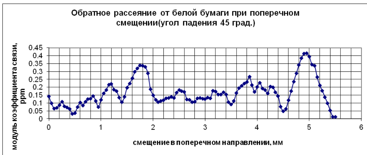
Рис.6. Зависимость модуля КС белой бумаги при смещении рассеивателя в поперечном направлении.
