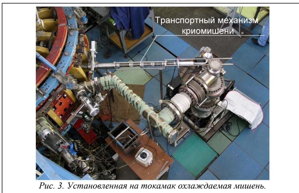
Рис. 3. Установленная на токамак охлаждаемая мишень.
