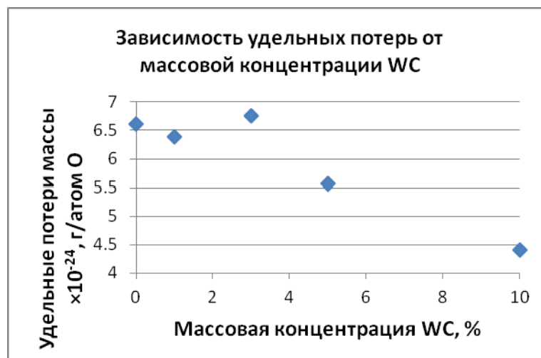
Рис. 4 Зависимость удельных потерь от массовой концентрации WC
