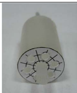
Рис. 3. Фотография составной преформы (а) и торца вытянутого из нее готового полимерного волокна (б).
