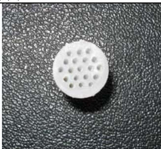
Рис. 2. Фотография микроструктурированной преформы с просверленными воздушными полостями.
