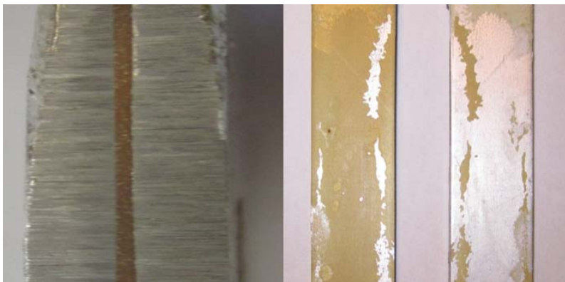
Рис. 1. Оптические фотографии торцевой поверхности (а) и поверхностей разрушения (б) образца клеевого соединения на основе клея К-300, подвергнутого длительной экспозиции в космосе.
