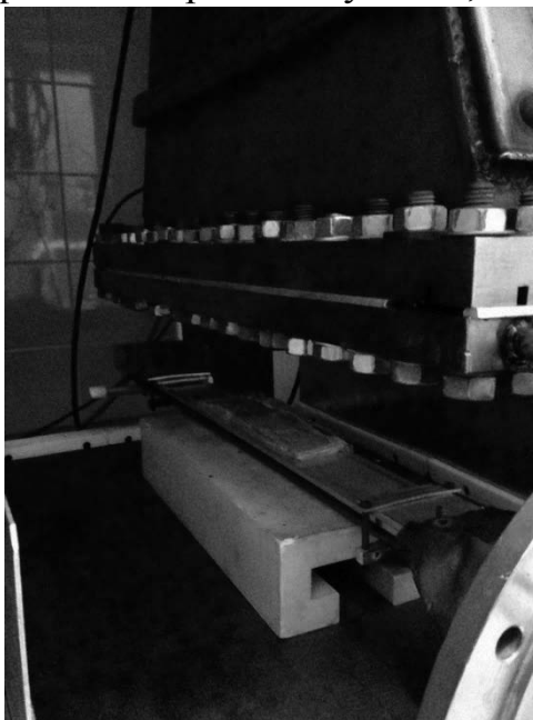
Рис.1. Облучение куска форели пучком ускоренных электронов с использованием ускорителя УЭЛР-1-25-Т001.
