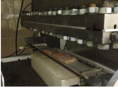
Рисунок 1. Фото образца и схема облучения куска форели пучком ускоренных электронов с использованием ускорителя УЭЛР-1-25-Т001 с энергией 1 МэВ
