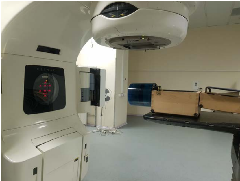
Рис. 1. Ускоритель Varian Clinac 2300 cd и фантом Catphan 504.
