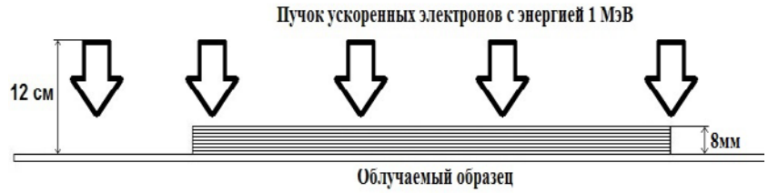
Рисунок 1. Фото образца и схема облучения куска форели пучком ускоренных электронов с использованием ускорителя УЭЛР-1-25-Т001 с энергией 1 МэВ
