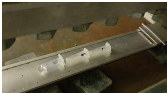
Рисунок 3. Схема облучения образцов пучком ускоренных электронов и фото образцов, подвергшихся воздействию ионизирующего излучения.
