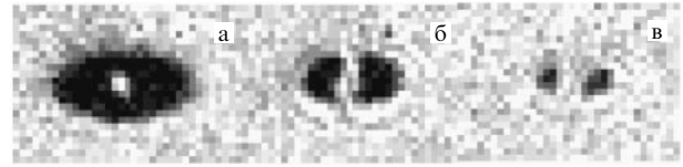
Рис. 4. Картина поглощения облаками атомов, захваченных в "оптически запертую" ловушку. (а) Облако уже холоднее, чем в случае без "оптической пробки" (луч аргонового лазера). (б) Облако расщеплено на два "кармана", расположенных около двух минимумов потенциала. (в) Облако, размер которого приближается к оптическому разрешению ( \leq 10 мкм), все еще поглощает 90 % пробного света. Этот случай соответствует верхней границе температуры ( \leq 10 мК) и нижней границе плотности ( 5 \times 10^{12} см ^{-3} ).
