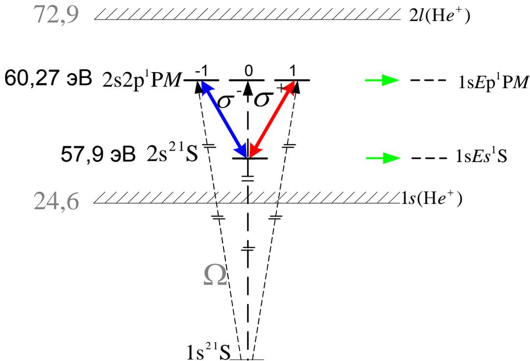
$\Omega$  – обозначает переходы, вызванные пробным полем. Красные стрелки - связи, индуцированные право поляризованным полем  $\sigma^+$ , синие – лево поляризованным  $\sigma^-$ .
